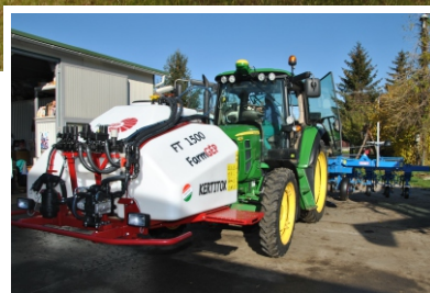
Front tartály sorpermetezéshez kultivátorra
